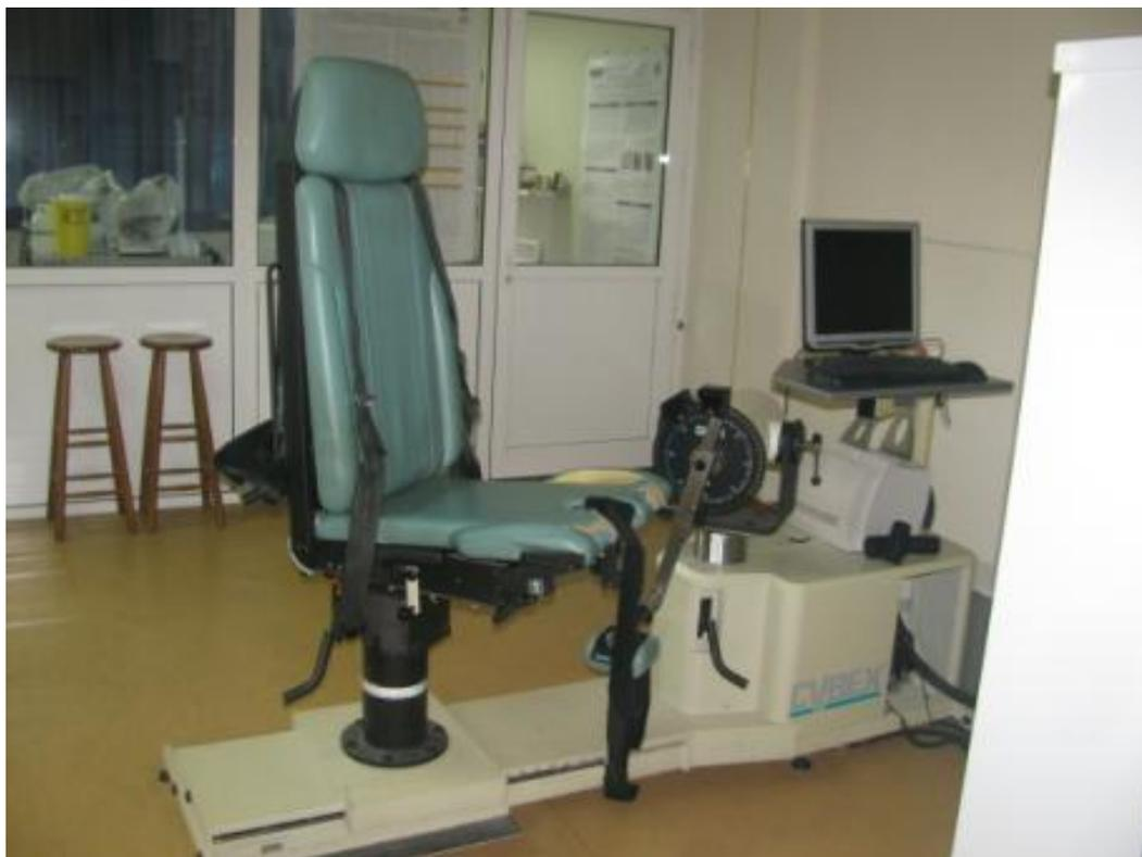
*Рис. 6. Тензодинамометрическое кресло*
