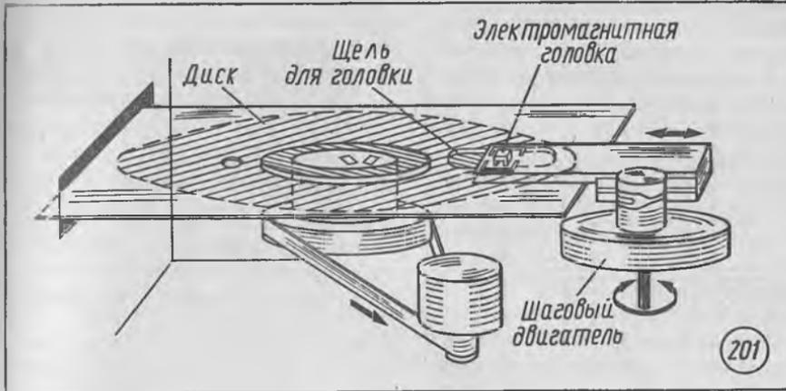
В персональных компьютерах для записи информации используется тонкий пластмассовый диск, покрытый слоем магнитного материала. Запись и считывание производится с помощью электромагнитной головки, перемещающейся над поверхностью диска по его радиусу (рис. 201). Диск вращается со скоростью 300
