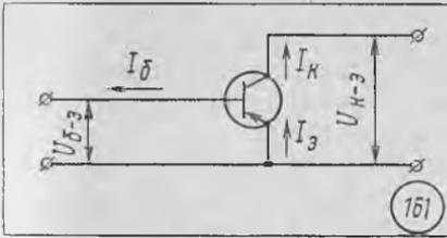
рекомбинации дырок в базе. Эти условия сильно зависят от типов использованных для изготовления транзисторов материалов и конструкции их электродов, но очень слабо зависят от коллекторного и базового напряжений. Поэтому транзистор можно рассматривать как устройство, распределяющее ток, протекающий через один из его электродов — эмиттер, в заданном соотношении между двумя другими электродами — базой и коллектором (рис. 161).
