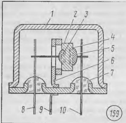
два  $p-n$ -перехода. Средняя область кристалла называется *базой* транзистора, а две крайние области кристалла, обладающие проводимостью противоположного базе типа, называются *коллектором* и *эмиттером* (рис. 159). Транзисторы, в которых эмиттер и коллектор обладают дырочной проводимостью, а база — электронной, называются транзисторами  $p-n-p$ -перехода.
