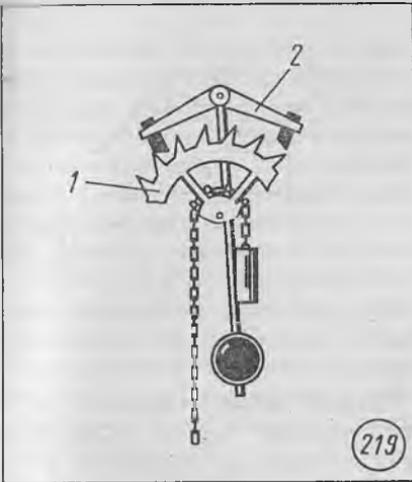
новными деталями устройства, осуществляющего обратную связь, служит храповое колесо 1 и анкер 2. Гиря (или пружина) вызывает вращение храпового колеса. При каждом колебании маятника зубец храпового колеса толкает анкерную вилку в таком направлении, что разгоняет маятник. В результате запас энергии, израсходованной на трение, восполняется за счет энергии гири, поднятой над землей, или закрученной пружины. Вращение стрелок часов осуществляется с помощью зубчатых колес от храпового колеса.
