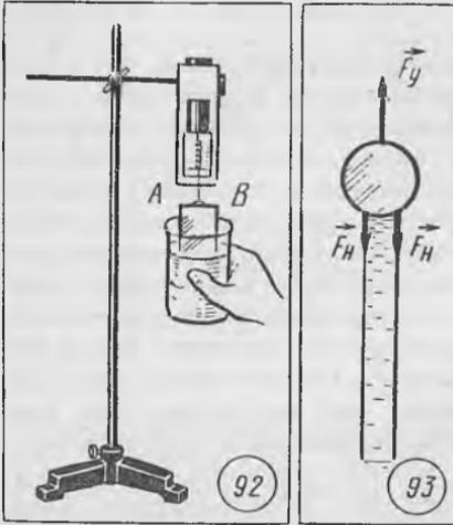
ка жидкости и пружина динамометра растягивается. По показаниям динамометра можно определить силу поверхностного натяжения. При этом следует учесть, что пленка жидкости имеет две поверхности (рис. 93) и сила упругости  $\vec{F}_y$  равна по модулю удвоенному значению силы поверхностного натяжения  $\vec{F}_x$ :
