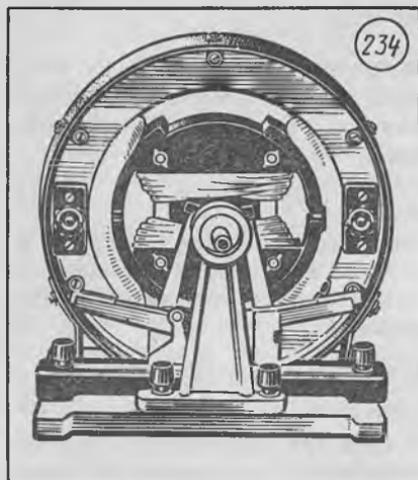
ток. Поэтому в генераторах переменного тока большой мощности электромагнит является ротором, т. е. вращающейся частью машины (рис. 234). При вращении ротора возникает переменная ЭДС индукции в обмотках, расположенных в неподвижной части генератора — в статоре. Для увеличения ЭДС индукции используется обмотка статора с большим числом витков. Для увеличения магнитного потока эту обмотку наматывают на стальной сердечник и зазор между сердечниками статора и ротора делают как можно меньшим.
