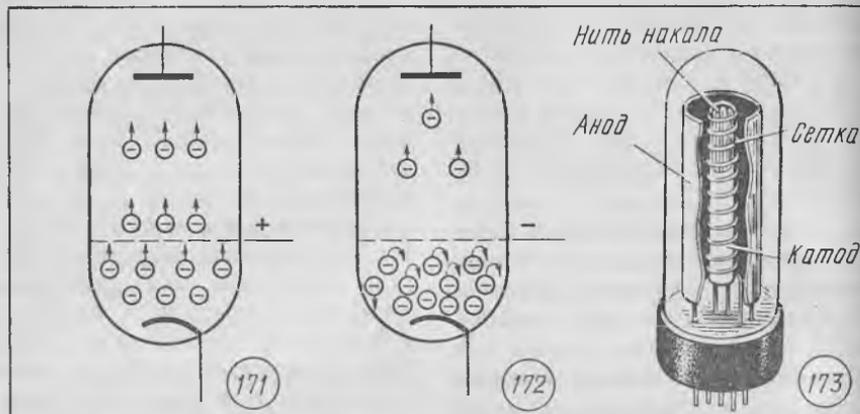
пролетает от катода к аноду, и в цепи анода существует электрический ток. При подаче на сетку отрицательного потенциала относительно катода электрическое поле между сеткой и катодом препятствует движению электронов от катода к аноду (рис. 172), анодный ток убывает. Таким образом, изменяя напряжение между сеткой и катодом, можно регулировать силу тока в цепи анода.
