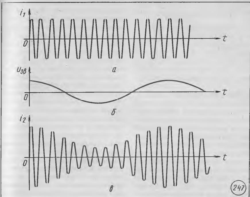
(рис. 247, а) в электрическую цепь транзисторного генератора последовательно с колебательным контуром включают катушку трансформатора (рис. 248). На вторую катушку трансформатора подается переменное напряжение звуковой частоты, например, с выхода микрофона после необходимого уси-
