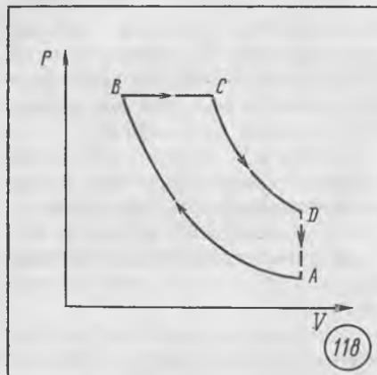
пература горения смеси (480—630 °С) у них выше, чем у карбюраторных двигателей (330—480 °С). Этим обеспечивается более полное сгорание дизельного топлива. Дизельные двигатели используются в мощных грузовых автомобилях, тракторах, на судах речного и морского транспорта, тепловозах.
