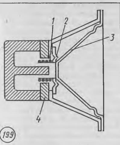
Для обратного преобразования электрических колебаний в звуковые применяется громкоговоритель. В громкоговорителе катушка 1 (рис. 199) из медного провода соединена с гибкой мембраной 2 и коническим диффузором 3. Катушка находится в магнитном поле постоянного магнита 4. При протекании переменного тока катушка под действием переменной силы Ампера колеблется с частотой колебаний силы тока. Катушка заставляет колебаться с такой же частотой мембрану и диффузор. Эти коле-
