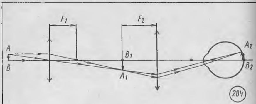
система из двух линз. Предмет помещается перед линзой, служащей объективом, на расстоянии  $d$ , удовлетворяющем условию  $F_1 < d < 2F_1$ , и рассматривается через окуляр, используемый в качестве лупы (рис. 284). Увеличение  $\Gamma$ , получаемое с помощью микроскопа, равно произведению увеличения объектива  $\Gamma_1$  на увеличение окуляра  $\Gamma_2$ .
