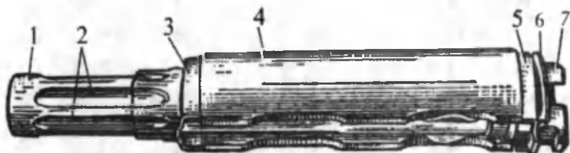
89-rasm. Gaz trubkasi stvol qoplamasi bilan birgalikda:
