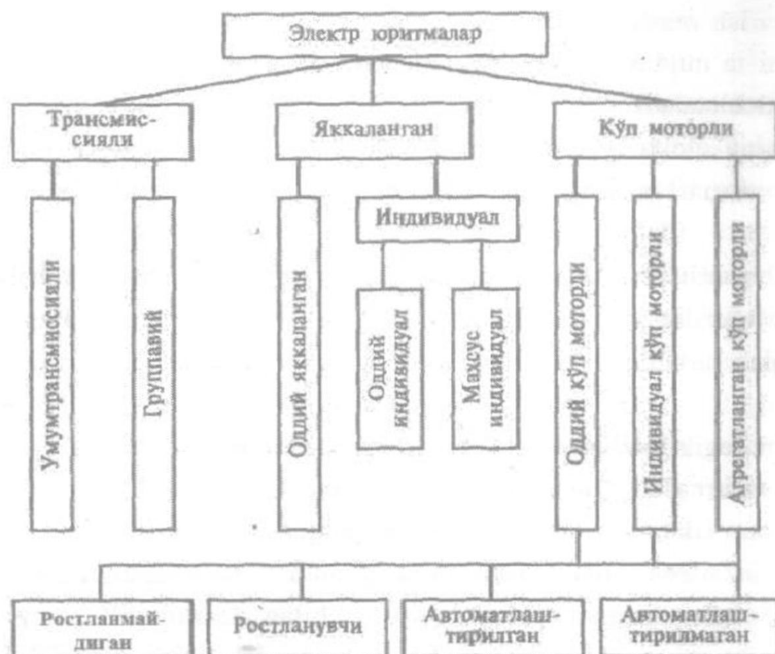
Rasm.6.1. Elektr yuritmalar klassifikatsiyasi sxemasi.
