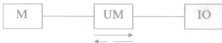
Rasm 6.6. Elektr yuritma mexanik qismi strukturaviy sxemasi.
