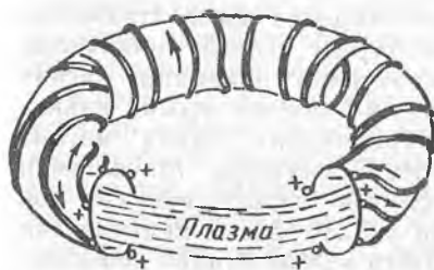
7. 14- расм. Плазмали тор ёки стелларатор типидаги қурилма.
